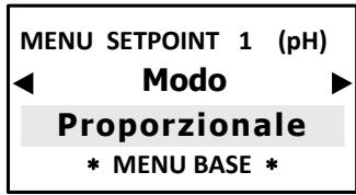
Gli impulsi modulari, conosciuti anche come PWM “pulse width modulation”, permettono una modalità proporzionale su ogni setpoint ON-OFF attivando gli impulsi corrispondenti sui relè in base al valore misurato.
