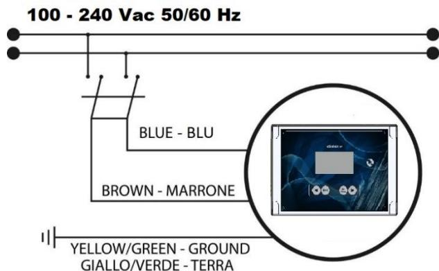
Fig. 1 – Collegamento elettrico
