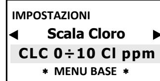
**IMPORTANTE:** una volta selezionato la **SCALA CLORO**, **ASSICURARSI** di collegare il sensore di CLORO appropriato.
