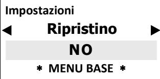
**RIPRISTINO DATI:** ripristina le impostazioni di fabbrica in default. Da utilizzare SOLO quando i parametri non corrispondono o se ci sono problemi nella programmazione o quando l'operatore intende ripartire da zero. Da NON abusare in quanto molti ripristini possono inficiare l'efficienza dello strumento.
