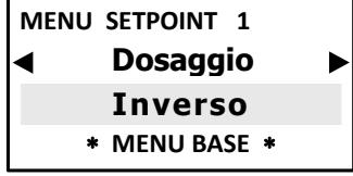
L'unità è fornita di modalità **ON-OFF** che attiverà o disattiverà (nel caso in cui la modalità inversa sia ON) i relè di uscita di pompe dosatrici Costanti / ON-OFF o di altri apparecchi con modalità ON-OFF.
