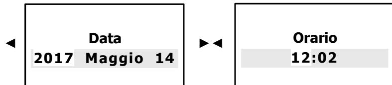
In alcune applicazioni può nascere l'esigenza di dover programmare l'attivazione o la disattivazione dello strumento, per questo motivo il dispositivo elettronico è provvisto di orologio e datario.
