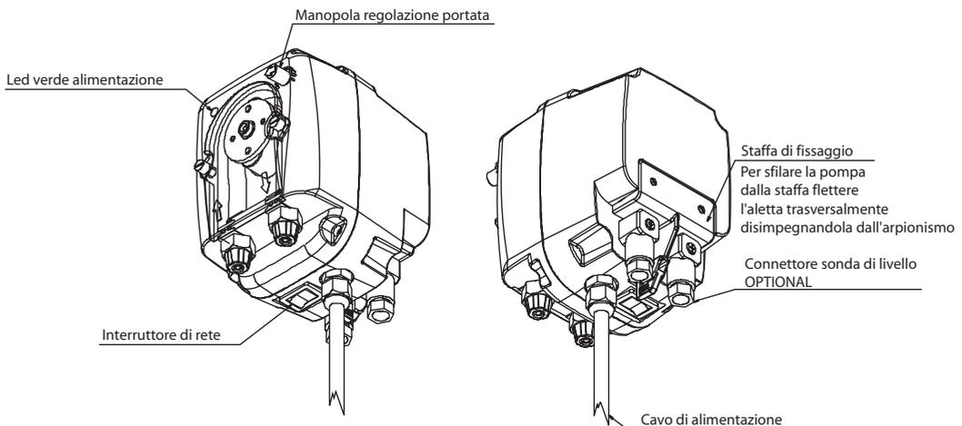
**N.B.:** se la pompa dosatrice è predisposta per il controllo di livello (sonda e galleggiante non compresi nella fornitura), venendo a mancare l'additivo nel contenitore, il LED verde (alimentazione) si illumina di giallo e la pompa non effettua più iniezioni.
